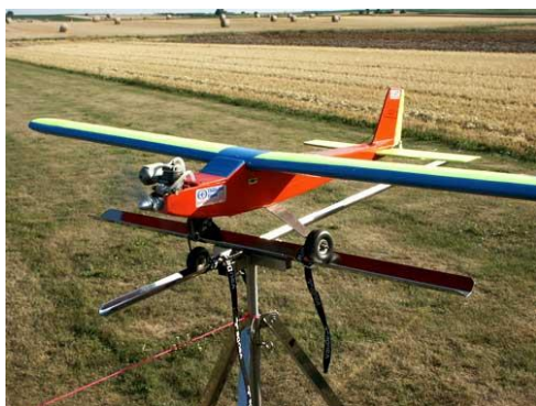
Beispiel, wie ein Flugmodell auf einer Haltevorrichtung befestigt werden kann
