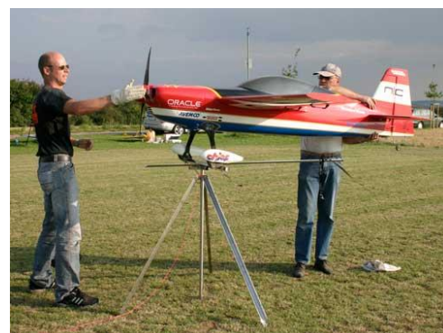
Hier fehlt eine flexible Höhenverstellung, sodass die Propellernabe etwa 40 Zentimeter zu hoch ist
